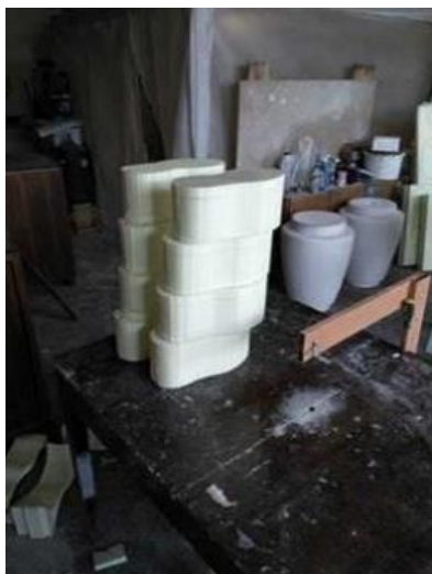
4.23.att. Izgriezta aptuvenā zoles forma; 4.24.att. Zole pirms slīpēšanas
