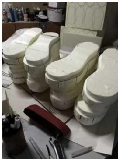
4.23.att. Izgriezta aptuvenā zoles forma; 4.24.att. Zole pirms slīpēšanas
